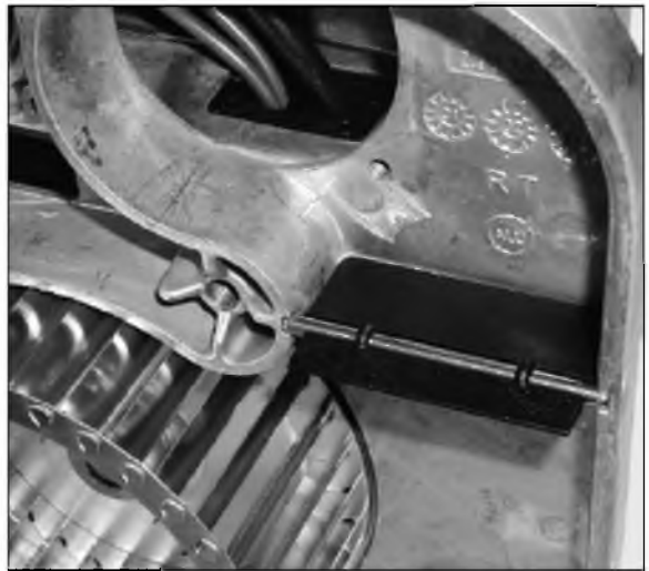
Рисунок 28 – Место установки воздушной заслонки
