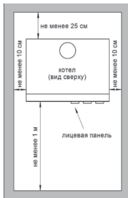
Рис. 5 – Схема установки котла
